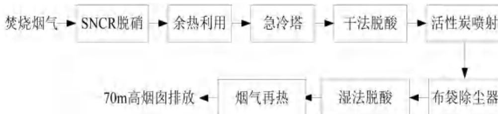
图 4.1-3 焚烧炉烟气处理工艺流程图
